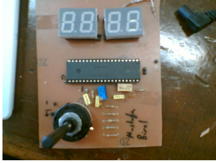
Şekil 10: Devre Elemanları Lehimlendikten Sonra
